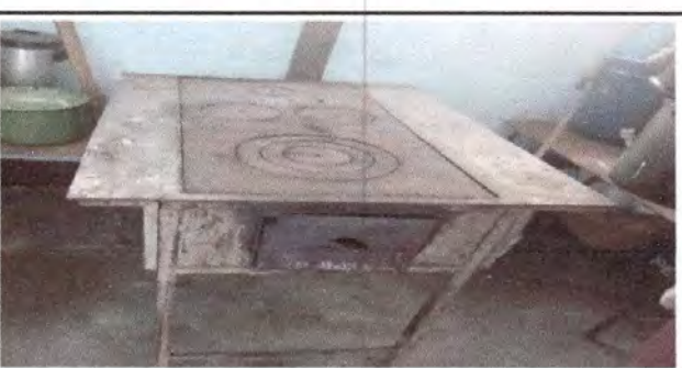
Foto 6: (Modulo 1) Sustitución de plancha de metal de tres hornillos
